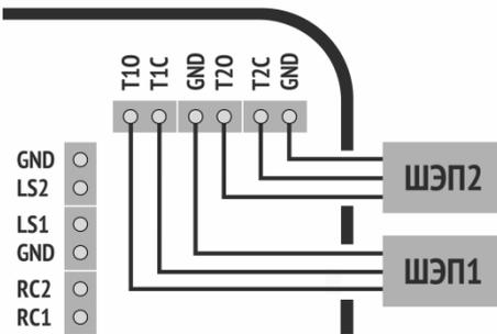
Рисунок 8.1 – Трехпроводная схема подключения ШЭП
