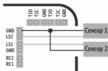
Рисунок 8.4 – Схема подключения сенсоров протечки воды
