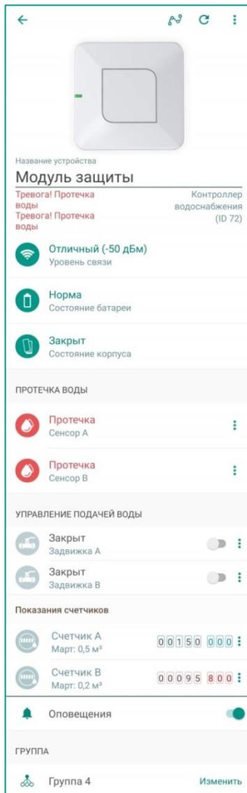
Рисунок 12.2 – Экран настройки модуля (оба сенсора обнаружили протечку)
