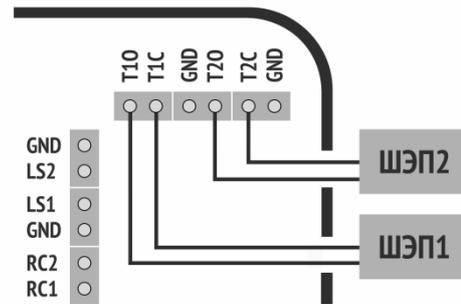
Рисунок 8.2 – Двухпроводная схема подключения ШЭП
