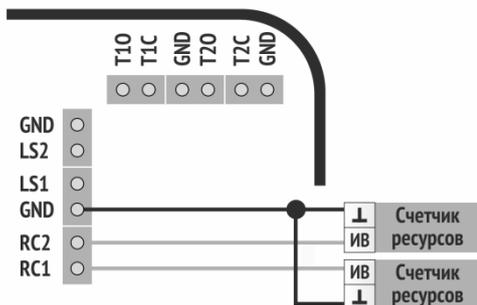
Рисунок 8.3 – Схема подключения счетчиков воды
