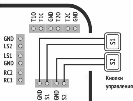
Рисунок 8.5 – Схема подключения кнопок управления ШЭП<sup>10</sup>
