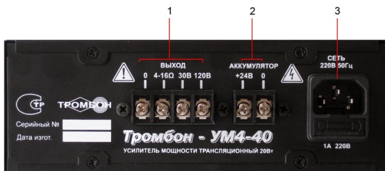
Рис. 2 Эскиз задней панели Усилителя
