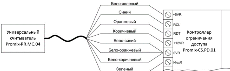
Рис.7. Подключение считывателя к контроллеру Promix-CS.PD.01
