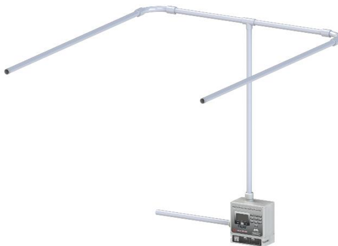
Рисунок 4 – Воздухозаборный трубопровод с 2 симметричными ветвями
